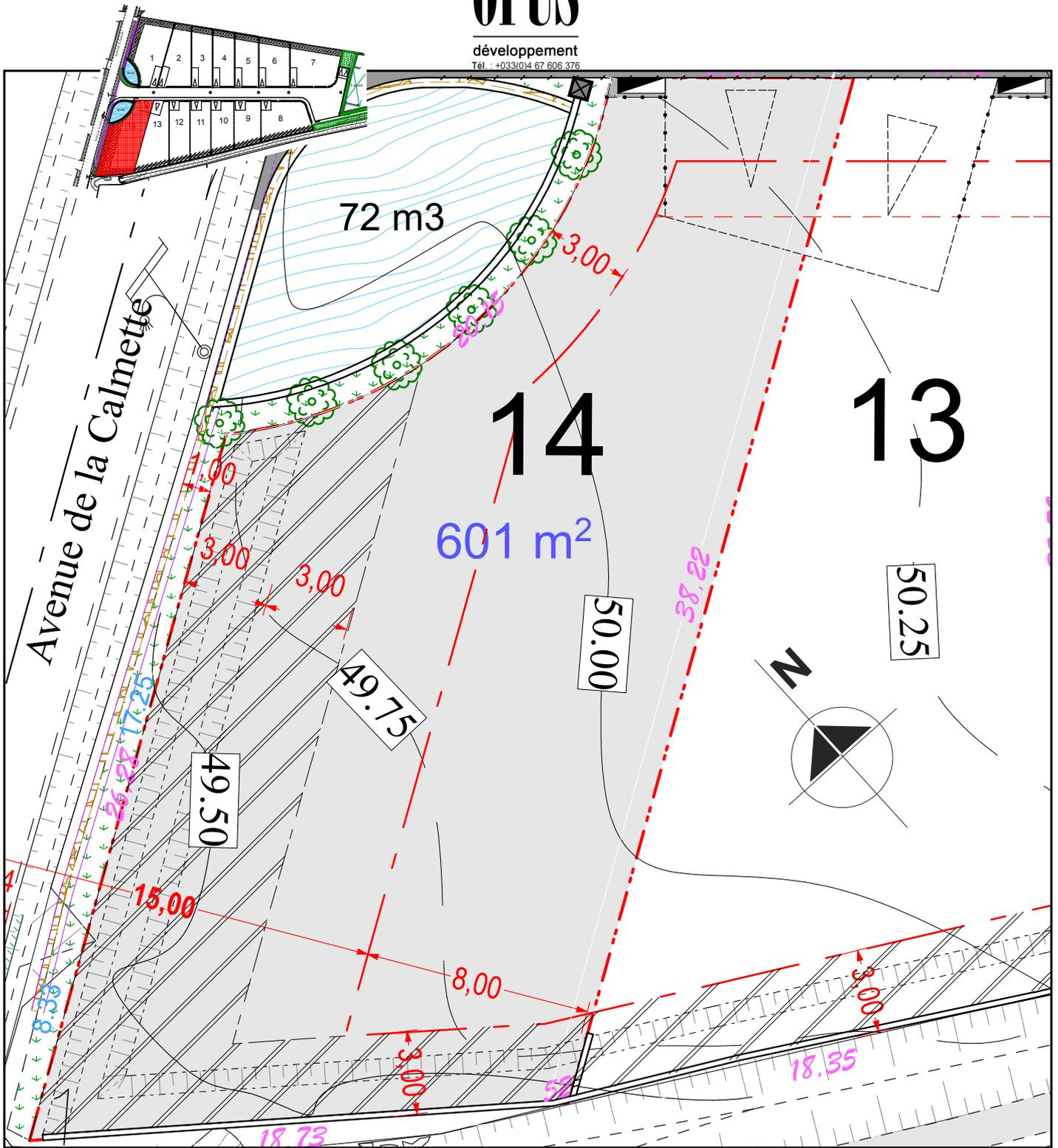
Emplacement projeté de l'enveloppe béton recevant, l'alimentation d'eau potable et le réseau télécom en regard. L'acquéreur et le constructeur devront tenir compte de l'emplacement de ces ouvrages, lors de l'établissement du projet ainsi que lors de la réalisation de la construction. Pour des raisons techniques, l'aménageur se réserve la possibilité de modifier la position de ces coffrets.
